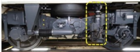
「TRAIN SUITE 四季島」の上下制振制御システム
