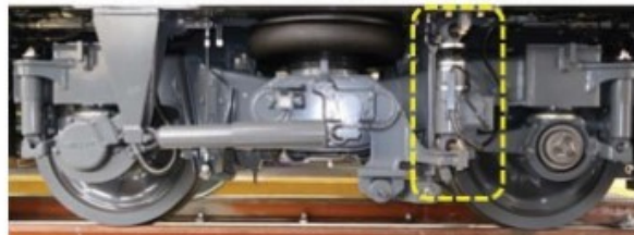
「TWILIGHT EXPRESS 瑞風」の上下制振制御システム
