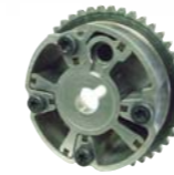
バルブタイミング コントロールシステム (VTC)
